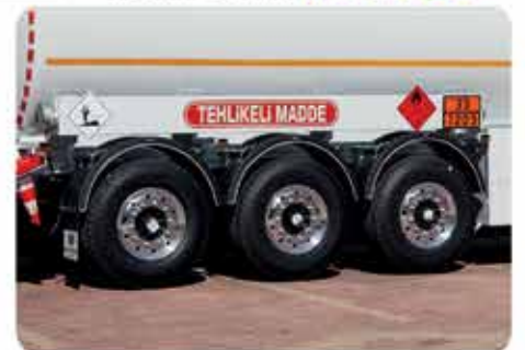
Storage box for offload hose at the sides, 4mm plas- tic. Tyres 385/65 R 22.5 6+1 Boşaltım hortumu için yanlarda 4mm plastikten özel kılıf. Lastik ebatı: 385/65 R 22.5 6+1
