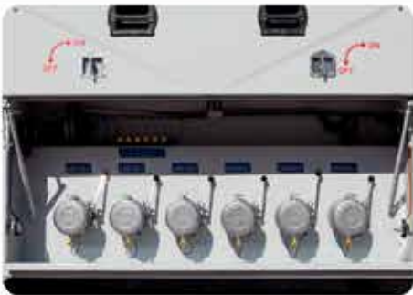
4" API offload adaptors, pneumatic brake system against moving when the box cap is open 4" Boşaltım adaptörü, dolap kapağı açıkken hareket önleyici pnömatik fren sistemi
