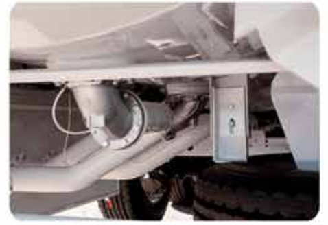
Seperate offload pipes and bottom valves Boşaltım için müstakil dip vanası ve boruları
